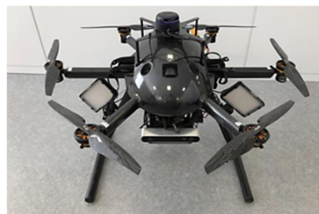
高所点検ドローン
